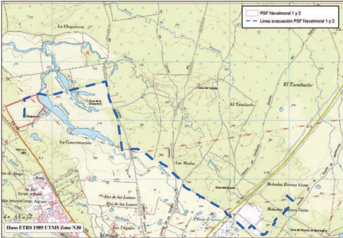
Imagen 4: Trazado LE soterrada de evacuación de las PSFV Navalморal 2 sobre topográfico
