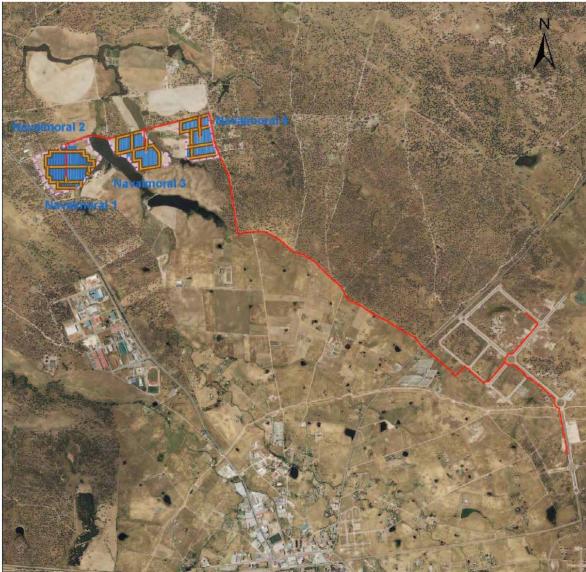
Imagen 1: Implantación definitiva para instalación de las 4 PSFV (entre ellas PSFV Navalmoral 2) y su sistema de evacuación
