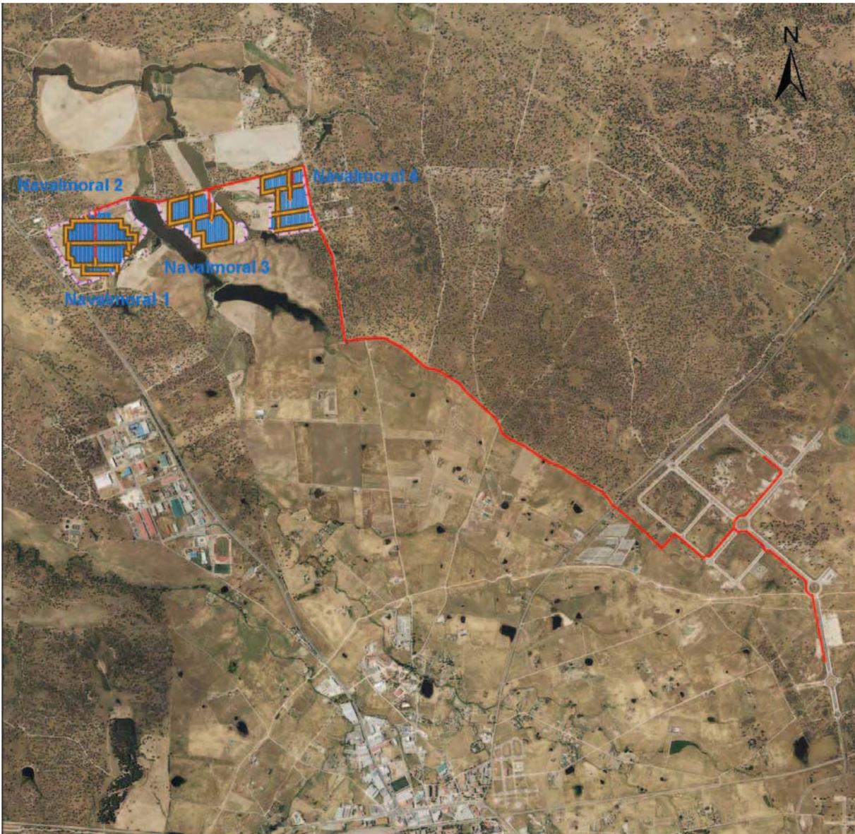
Figura 2: Implantación definitiva para instalación de (en rojo líneas eléctricas de evacuación). Entre ellas PSFV Navalморal 2
