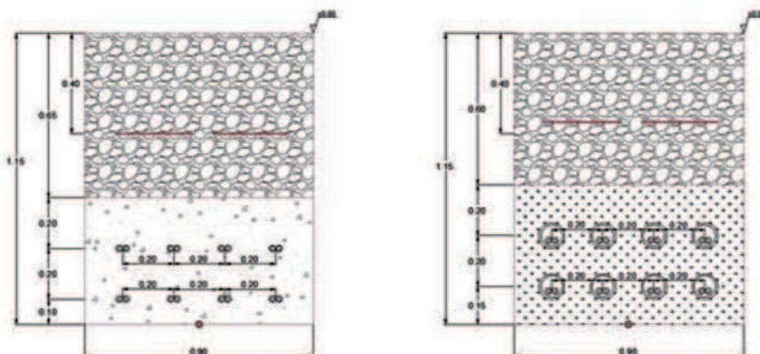
Imagen 10: Detalle de zanjas para circuitos de Baja Tensión (izqda.) y de zanjas bajo camino (dcha.)
